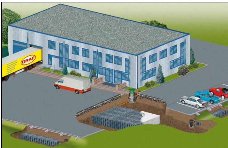
Figur 15. Exempel på utjämningsmagasin bestående av dagvattenkassetter (Uponor)
